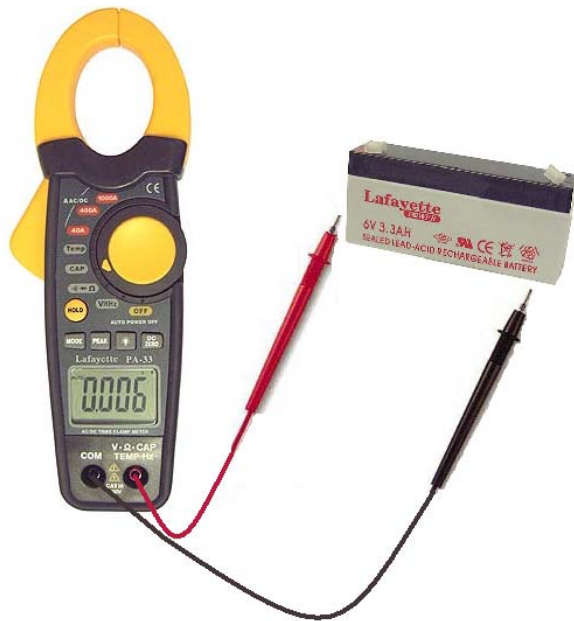
Esempio di misura di una tensione DC
